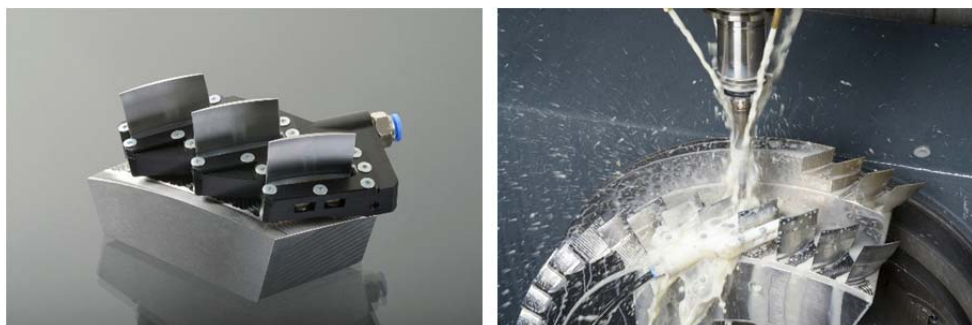
Abbildung 66: Nutzung eines Spann- und Stabilisiersystems (links) zur prozessstabilen Schlichtfräsbearbeitung einer Multi-BLIR. Das stabilisierende Spannsystem ermöglicht signifikant erhöhte Schnittgeschwindigkeiten und Oberflächengüten. Rechts: Systemtest mit einem ersten Prototyp aus Kunststoff.
