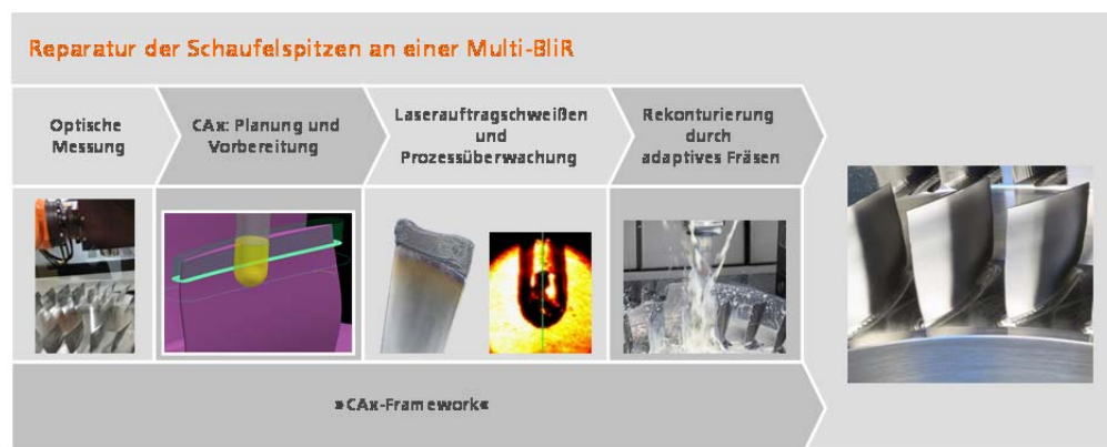
Abbildung 4: Darstellung der Prozesskette und der Abfolge der Prozessschritte zur Reparatur einer Multi-BliR.
