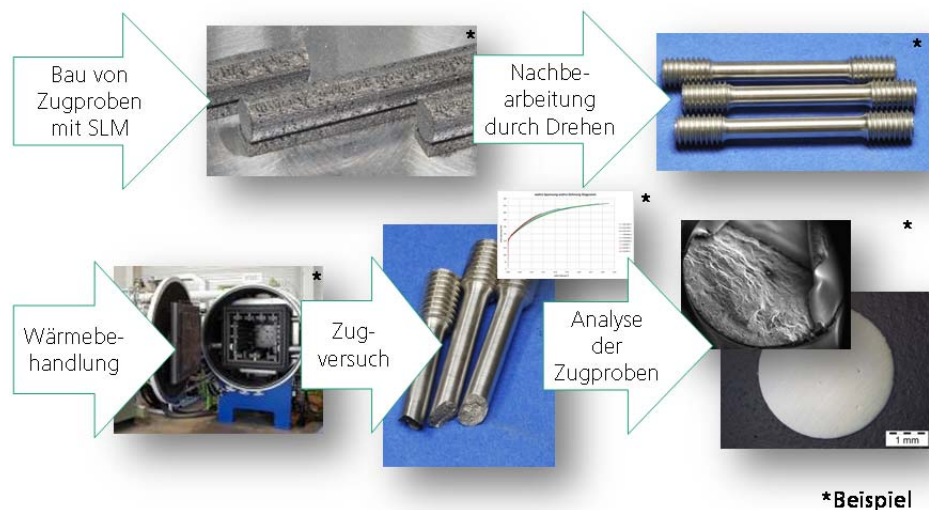
Abbildung 24: Weg von Erstellung der Probekörper bis zur Analyse der mechanischen Kennwerte
