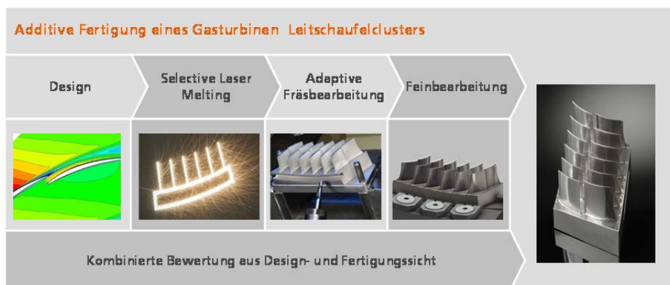
Abbildung 3: Beispielhafte Darstellung der Prozesskette zur Fertigung des Leitschaukelclusters mittels SLM
