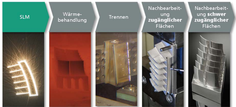
Abbildung 27: Darstellung der generativen Prozesskette zur Fertigung des Leitschaufelclusters
